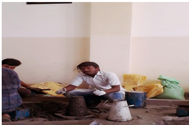
Fig no: 3.6 Slump Cone Test
