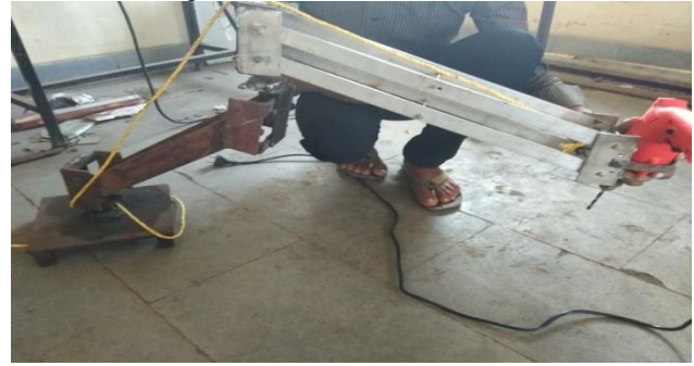
Fig. 4: (d) Up/Down Movement of Upper Arm about Horizontal Hinge
