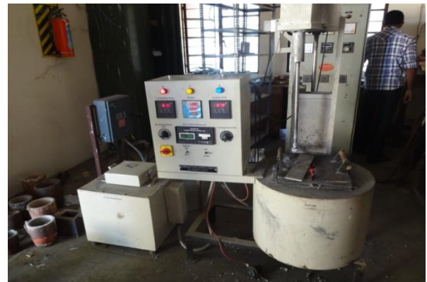
Fig. 2 Stir casting apparatus
